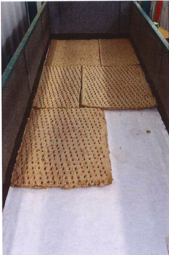
Abb. 2: Secalfor-Panel auf Schutzvlies 300 g (links) und abgesandete erste Lage (rechts)
