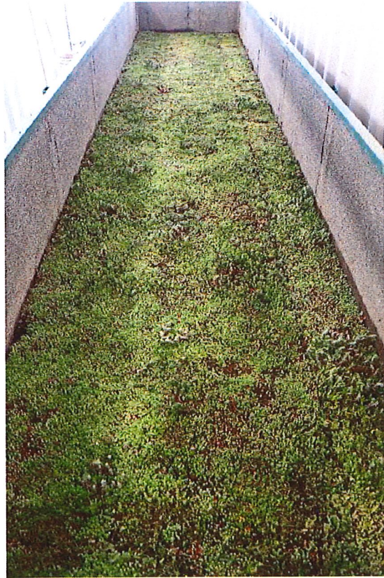
Abb. 3: Secalfor-Panel vollflächig verlegt (links) und vollständiger Systemaufbau mit Vegetationsmatte (rechts)
