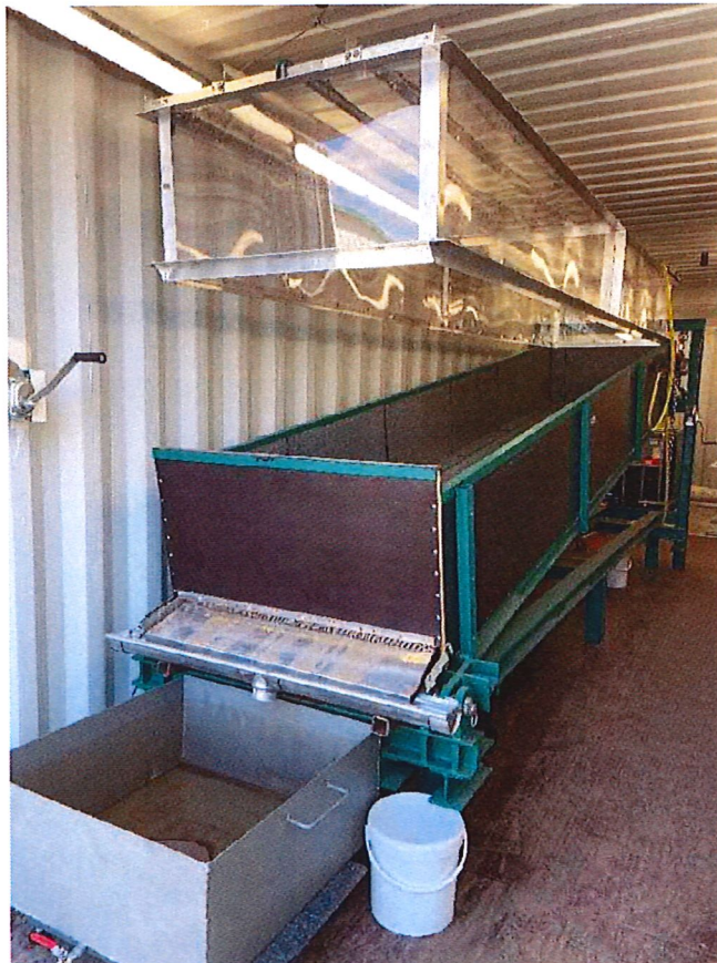
Abb. 1: Messgerät zur Abflussbestimmung
