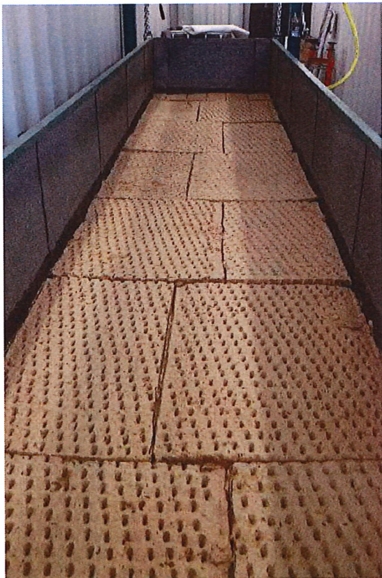
Abb. 3: Secalfor-Panel vollflächig verlegt (links) und vollständiger Systemaufbau mit Vegetationsmatte (rechts)
