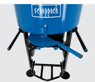
Der Auslasshebel ermöglicht eine feine Dosierung des Mischgutes bei der Entleerung
