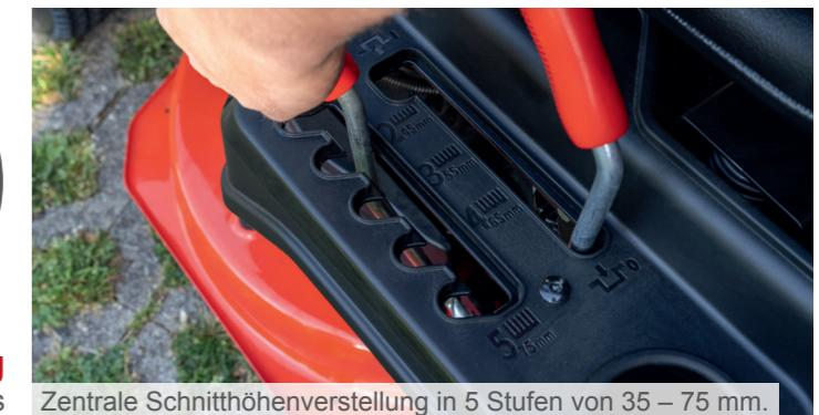
Zentrale Schnitthöhenverstellung in 5 Stufen von 35 – 75 mm.
