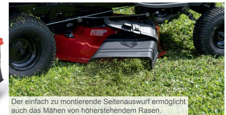
Der einfach zu montierende Seitenauswurf ermöglicht
