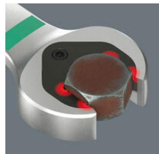
Die clevere Doppelsechskant-Geometrie des Jokers macht die Verbindung mit Schraube oder Mutter formschlüssig - das sitzt. Und die auswechselbare, gehärtete Metallplatte im Maul des Jokers verbeißt sich mit extrem harten Spitzen in die Schraube. Beides verringert die Abrutschgefahr auch bei hohen Drehmomenten.
