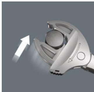
Durch die automatisch stufenlos zugreifenden parallel geführten Backen deckt der Joker Doppelmaulschlüssel 6006 alle Abmessungen im jeweiligen Anwendungsbereich ab. Die benötigte Größe findet der Schlüssel beim Ansetzen an der Mutter oder Schraube ohne Einstellen von selbst.
