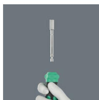
Durch erneutes, kräftigeres Betätigen der Arretierhülse wird der Lösemechanismus durch ein deutlich hör- und fühlbares Überwinden des Arretierwiderstandes gelöst. Die Teleskopklinge kann entnommen und als Bitadapter in Elektro-Schraubern eingesetzt werden.
