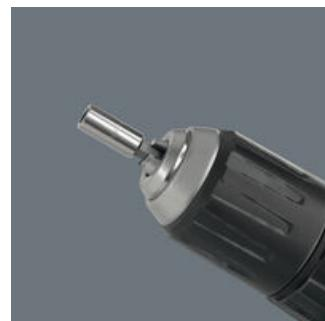
Universalhalter für die Aufnahme von Bits mit 1/4"-Außensechskant antrieb. Edelstahlhülse für besonderen Korrosionsschutz. Der Sprengring garantiert optimalen Sitz des Werkzeugs im Halter. Der starke Dauermagnet hält die Bits bombenfest. Passend für Schraubermaschinen mit Aufnahme nach DIN ISO 1173-F 6,3.
