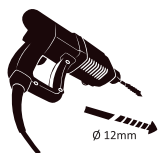
Bohrer mit 12 mm Bit für Beton
