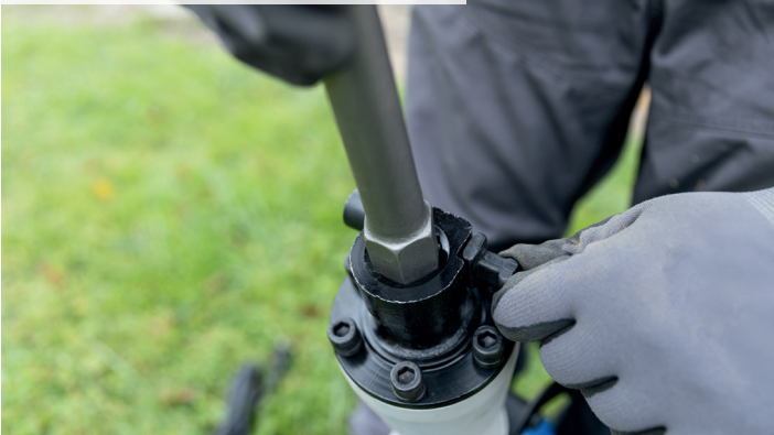
Einfacher und schneller Werkzeugwechsel über 30 mm Hexagon Werkzeugaufnahme
