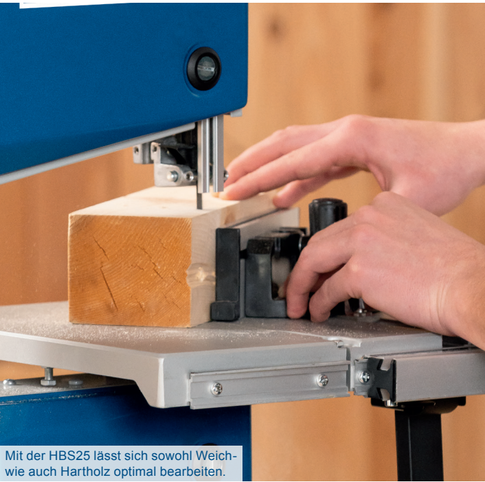
Stabiler Sägertisch, ideal für extra große Werkstücke.
