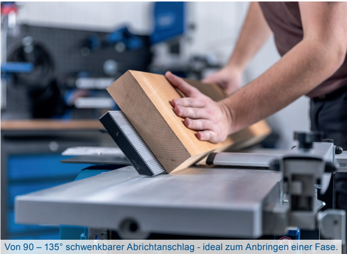
Von 90 – 135° schwenkbarer Abrichtanschlag - ideal zum Anbringen einer Fase.
