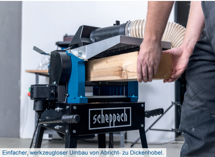
Einfacher, werkzeugloser Umbau von Abricht- zu Dickenhobel.
