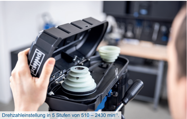
Drehzahleinstellung in 5 Stufen von 510 – 2430 min -1 .
