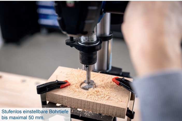
Hochwertiges, kugelgelagertes Zahnkranzbohrfutter für gängige Bohrer von 1,5 bis 13 mm.
