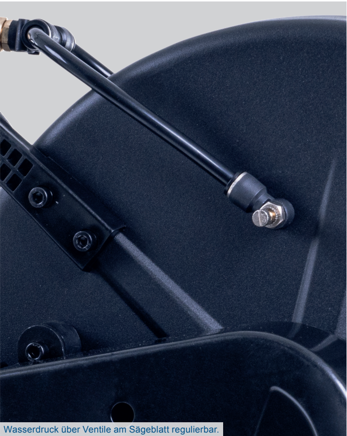
Wasserdruck über Ventile am Sägeblatt regulierbar.
