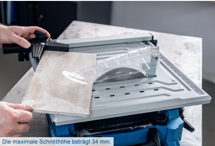
Die maximale Schnitthöhe beträgt 34 mm.
