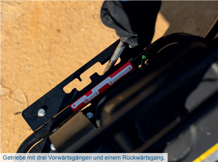
Getriebe mit drei Vorwärtsgängen und einem Rückwärtsgang.
