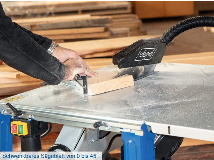
Schwenkbares Sägeblatt von 0 bis 45°.
