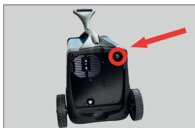
Auf der Rückseite des Schutzgasschweißgerätes SSG 145 (CFH-No. 52 860) befindet sich der Anschluss für die MIG-MAG Schlauchgarnitur CFH-No. 52 812 (s. roter Kreis).
