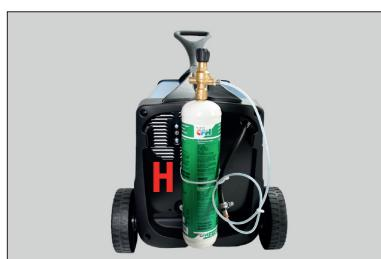
Befestigen Sie die Argon-Flasche (z.B. mit einem Kabelbinder) am Gehäuse (s. Abb. H) des Schutzgasschweißgerätes SSG 145 (CFH-No. 52 860).
