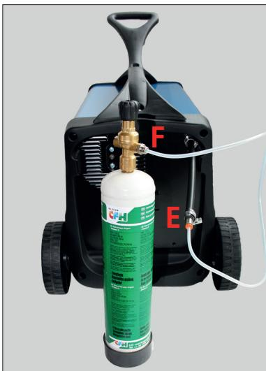
Verbinden Sie das eine Ende des durchsichtigen Schlauches mit dem Verbindungsniippel am schwarzen Schlauch (s. Abb. E).
