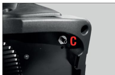
Stecken Sie das Schlauchende auf den Nippel (s. Abb. C) am Schutzgasschweißgerät SSG 145 (CFH-No. 52 860) und bringen Sie die 2. Schlauchschele so an, dass sich der Schlauch vom Nippel nicht mehr lösen kann (s. Abb. D).
