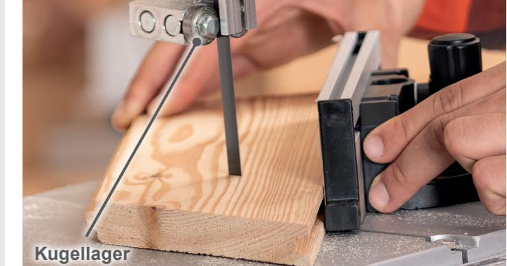
Winkelschnitte sind einfach und schnell umsetzbar, durch den stufenlos schwenkbaren Sägetisch.
