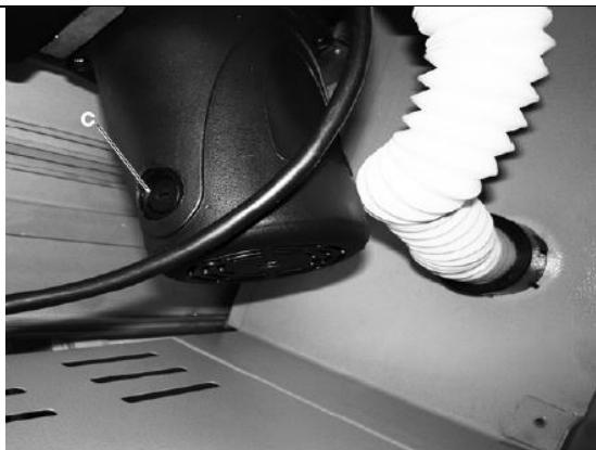
Überprüfen Sie die Kohlebürsten nach den ersten 50 Betriebsstunden mit einer neuen Maschine oder wenn neue Bürsten montiert sind. Nach Durchführung der ersten Kontrolle wiederholen Sie die Kontrolle alle 10 Betriebsstunden.
