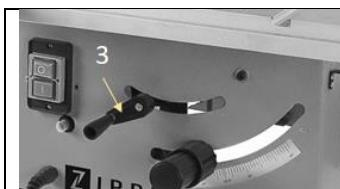
Das Sägeblatt kann durch die Kurbel (3) gehoben und gesenkt werden. Wenn die Kurbel im Urzeigersinn gedreht wird, wird das Sägeblatt gesenkt. Gegen den Uhrzeigersinn wird es gehoben
