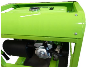
Odstránenie bočného krytu.
