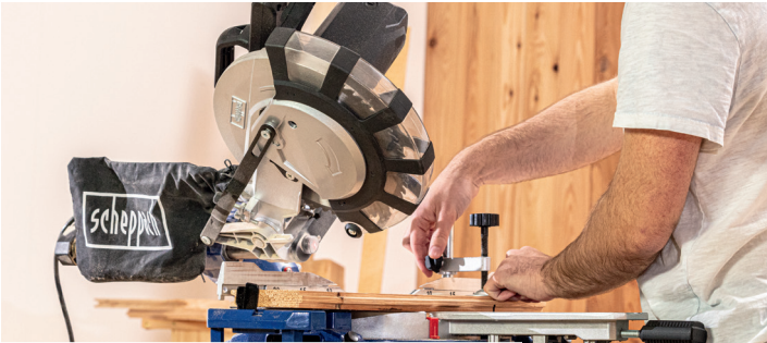
Geschlossener Sägeblattschutz für maximale Sicherheit.
