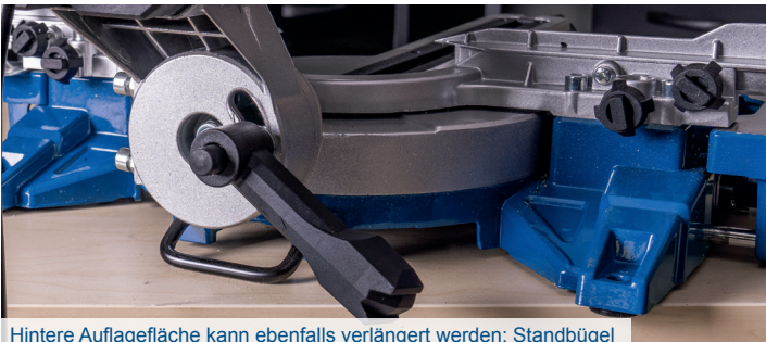
Hintere Auflagefläche kann ebenfalls verlängert werden; Standbügel sorgt für besonders sicheren Stand, speziell bei Neigungsschnitten.
