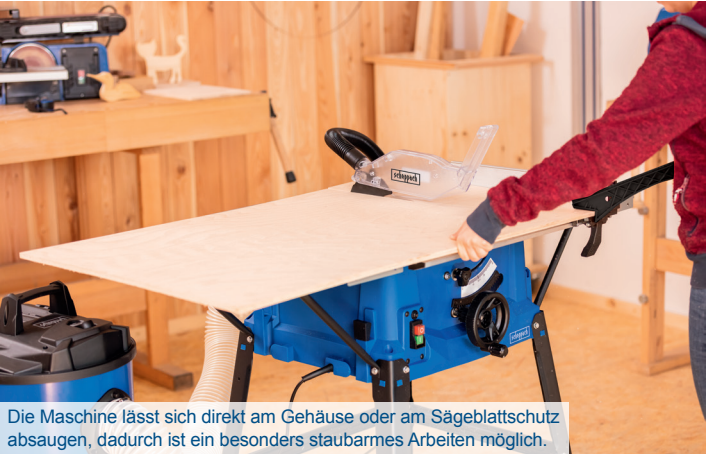
Ergonomische Arbeitshaltung dank einer Tischhöhe von 830 mm.
