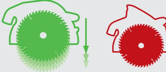
Der Vorteil gegenüber herkömmlichen Handkreissägen liegt in der Tauchfunktion. Mit dieser lassen problemlos spezielle Anforderungen, die ein Eintauchen des Sägeblattes erfordern, realisieren.
