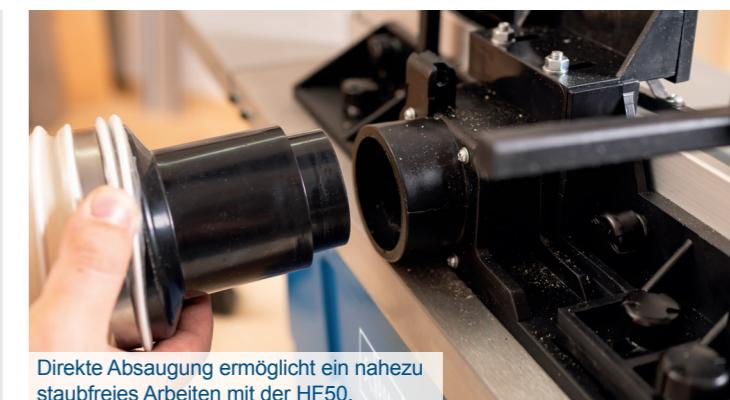
Direkte Absaugung ermöglicht ein nahezu staubfreies Arbeiten mit der HF50.
