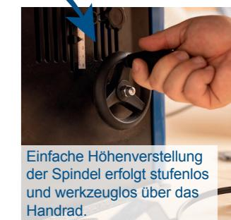
Einfache Höhenverstellung der Spindel erfolgt stufenlos und werkzeuglos über das Handrad.
