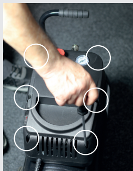
Abb. 3a: Schrauben entfernen
