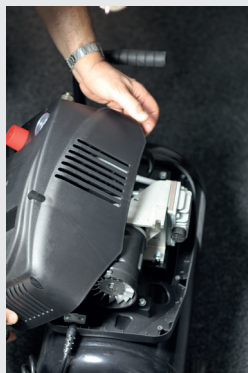
Abb. 3b: Abdeckung abheben
