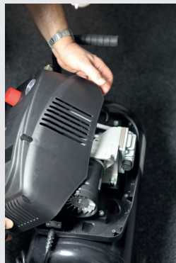
Abb. 3b: Abdeckung abheben
