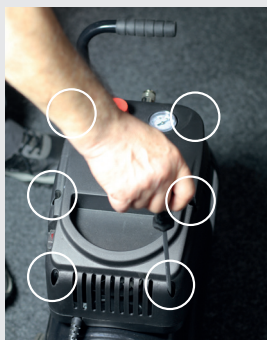
Abb. 3a: Schrauben entfernen
