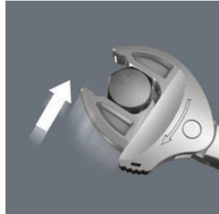
Durch die automatisch stufenlos zugreifenden parallel geführten Backen deckt der Joker Maulschlüssel 6004 alle Abmessungen im jeweiligen Anwendungsbereich ab. Die benötigte Größe findet der Schlüssel beim Ansetzen an der Mutter oder Schraube ohne Einstellen von selbst.
