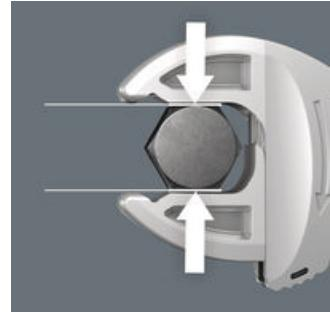
Die parallelen glatten Backen des Joker 6004 ermöglichen eine Flächenpressung und können dadurch das Verrunden der Mutter bzw. des Schraubenkopfes vermeiden, was bei der Kraftübertragung über Ecken auftreten kann.
