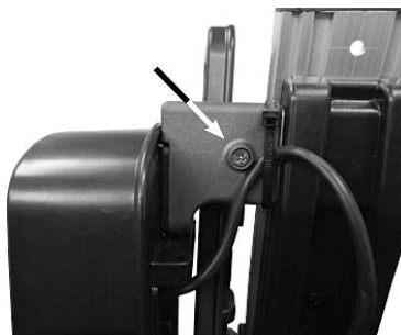
Figure 2 : Montage des feux arrière
