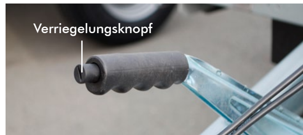
Handbremshebel mit seitlichen Zahnsegment (Abb. abweichend)
