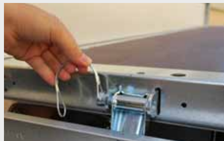
h) Bolzen mit Sicherungsbügel schließen
