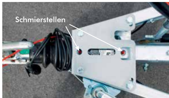
Schmierstellen der Auflaufeinrichtung
