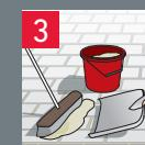
Fugen mit einem **feinen Nebel** aus einem Gartenschlauch mit Sprühpistole anfeuchten, um NO GROW™ DANSAND Kerama® zu verdichten.
