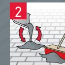
NO GROW™ DANSAND Kerama® vor Gebrauch gut vermengen. Das Fugenmaterial mit einem **weichen Besen** gerade und diagonal in die Fugen einfegen, bis diese komplett gefüllt sind. Den Belag anschließend von überschüssigem Material frei fegen.
