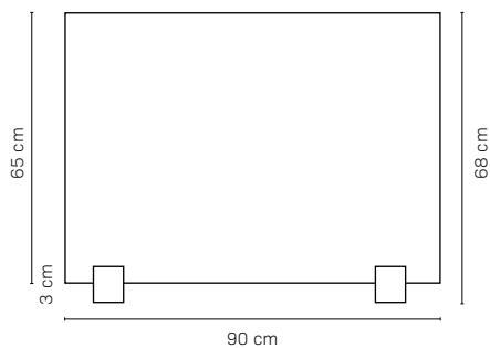
Klarglas 5mm, ESG, Kanten fein geschliffen
