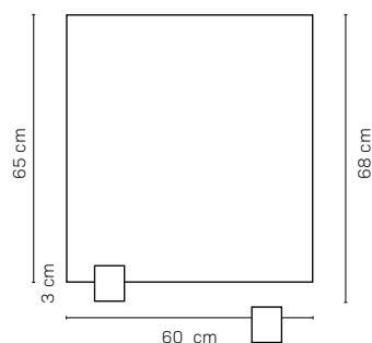
Klarglas 5mm, ESG, Kanten fein geschliffen
