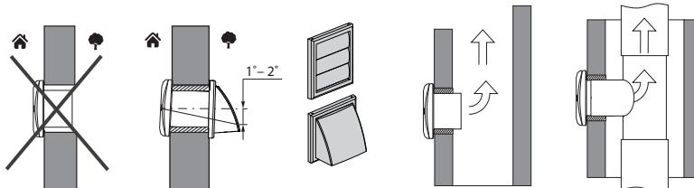
Das Lüftungsrohrsysteem darf nicht länger als 5 Meter sein und sollte maximal zwei Biegungen haben.
