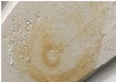
Produkte aus unserem Sortiment, die in den Farben Latte und Grau lackiert sind, werden im Spritzverfahren beschichtet, wodurch Äste und Holzmaserung vollständig überdeckt werden. Mit der Zeit können jedoch natürliche Verfärbungen an den Ästen auftreten, die typisch für Nadelholz sind. Farbveränderungen lassen sich durch punktuelles Abwischen mit einem mit 40% Alkohol getränkten Tuch reduzieren.
