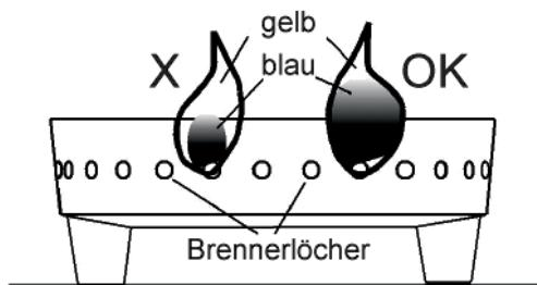
Sollte einer dieser Punkte nicht zutreffen, liegt eine Störung der/s Brenner(s) vor. Eine umgehende Reinigung der Brenner (und Ventile) ist erforderlich, um wieder einen sicheren Betrieb zu ermöglichen.
