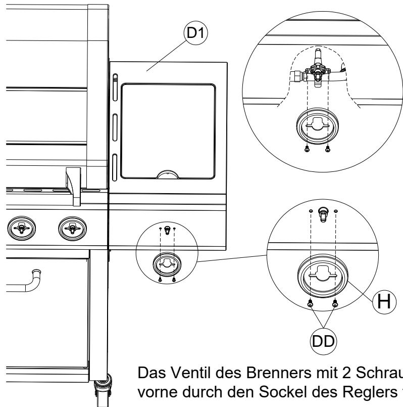
Das Ventil des Brenners mit 2 Schrauben DD von vorne durch den Sockel des Reglers fixieren.
