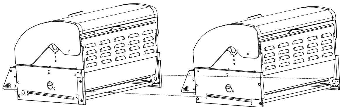
Bitte entfernen Sie diese Transportsicherung vor der Montage.
