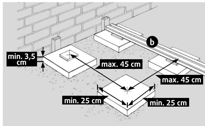
Verwenden Sie dazu Edelstahl-Senkpfoschrauben mit einem Durchmesser von 5 mm (zum Befestigen der Alu-Unterkonstruktion Edelstahl-Rundkopfschrauben ø 5 mm). Die Länge und Ausführung der Schrauben müssen auf den jeweiligen Untergrund abgestimmt sein. Zur Vermeidung von Staunässe und zum Ausgleich von leichten Unebenheiten empfehlen wir die Verwendung der Holz- und Bautenschutzunterlage **o**.
