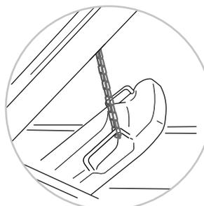
Schraubhaken und Kette montieren Sie bitte so, dass sich beim Anheben des Deckels die Mülltonne mit öffnet. Bei Tonnen die keine Möglichkeiten für eine Kettenbefestigung bieten, sollte der örtliche Entsorger/Eigentümer gefragt werden, ob der Kunststoffdeckel nachträglich gebohrt und mit einer Öse ausgestattet werden darf.
