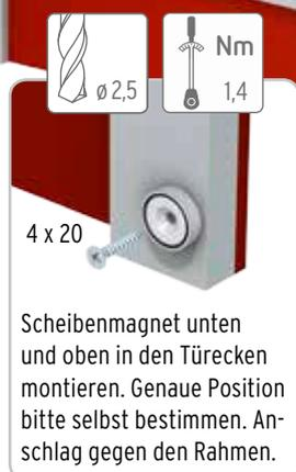
Scheibenmagnet unten und oben in den Türecke montieren. Genaue Position bitte selbst bestimmen. Anschlag gegen den Rahmen.
