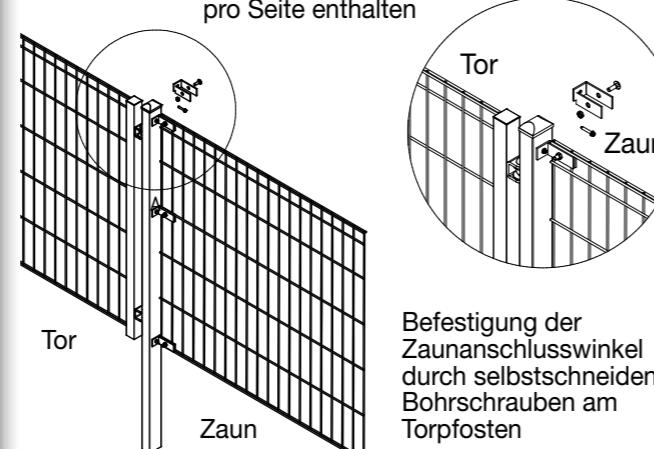
Befestigung der Zaunanschlusswinkel durch selbstschneidende Bohrschrauben am Torpfosten
