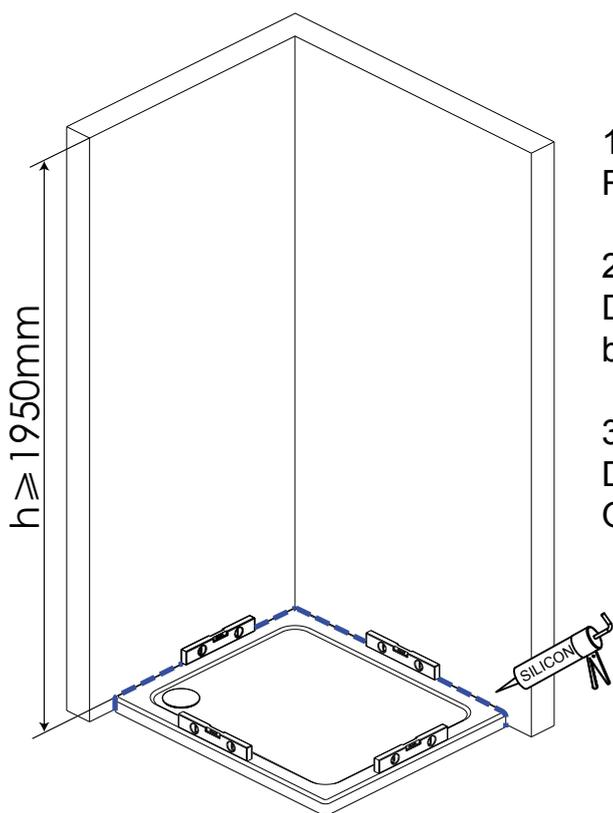
1. Stellen Sie sicher, dass die Duschwanne in alle Richtungen ausgerichtet ist.
