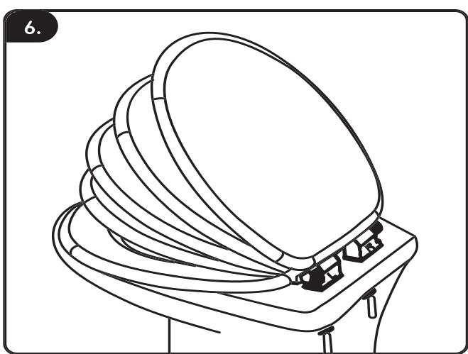
Scharniere mit einem maximalen Drehmoment von  $5 \pm 0,05$  Nm anziehen. Darauf achten, dass die Scharniere vollständig von der Unterlegscheibe abgedeckt sind. Achsen des Scharniers in das Loch des Sitzes einsetzen, bis sie dicht verschlossen sind.
