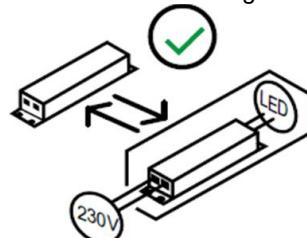
Dieses Produkt enthält ein separates Steuerung Zubehör, dass durch den Endbenutzer ausgetauscht werden kann.
