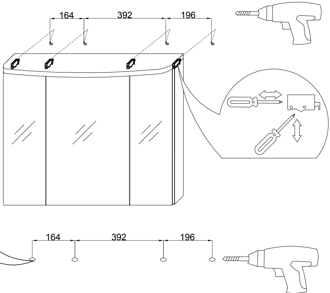
Schrauben und Dübel, für die Befestigung/Sicherung an der Wand, gehören nicht zum Lieferumfang.
