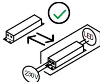
Dieses Produkt enthält ein separates Steuerung Zubehör, dass durch den Endbenutzer ausgetauscht werden kann.
