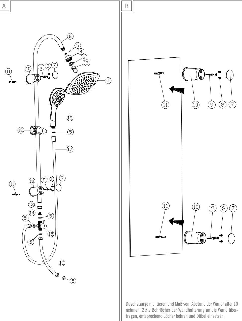
Duschstange montieren und Maß vom Abstand der Wandhalter 10 nehmen, 2 x 2 Bohrlöcher der Wandhalterung an die Wand übertragen, entsprechend Löcher bohren und Dübel einsetzen.
