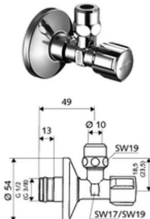
Zugfeste Messing-Konus-Quetschverschraubung mit Längenausgleich
