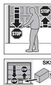
1. Stoppen Sie das Tor mit beiden Händen, während es **zufährt**. Die Toranlage muss anhalten und den Sicherheitsrücklauf einleiten.
