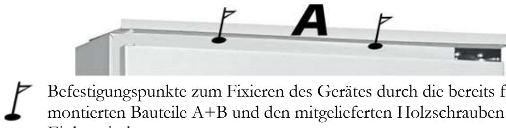
**F** Befestigungspunkte zum Fixieren des Gerätes durch die bereits fertig montierten Bauteile A+B und den mitgelieferten Holzschrauben in der Einbaunische.
