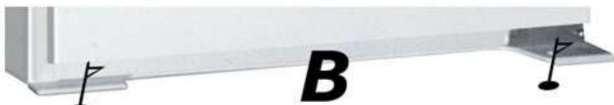
3. L'espace causé par le montage entre la niche d'intégration et l'appareil sera égalisé en insérant le joint plastique également fourni.
