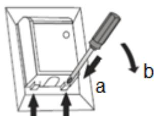
Abbildung 9 Netzanschlussdose
