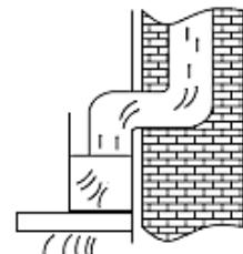
**Horizontal:** Der Abluftschlauch wird zu einer Auslassöffnung mit Gitter\* in der Hauswand geführt.
